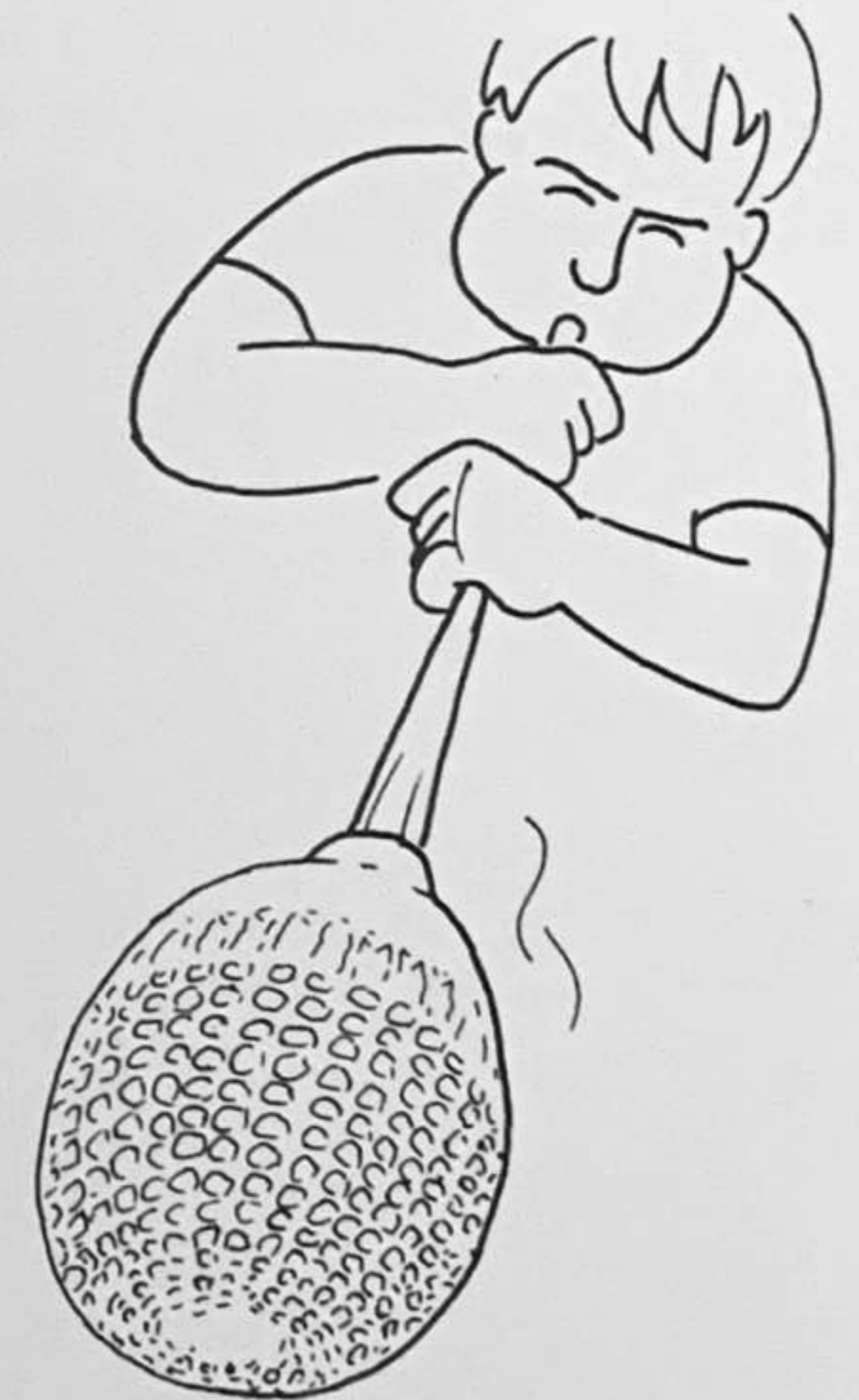
6 Nach kurzem Erhitzen am Ofen wird das Werkstück weiter ausgeblasen. Der aufgesponnene Faden reißt über den Rippenvertiefungen. Es entstehen Tupfenreihen.
