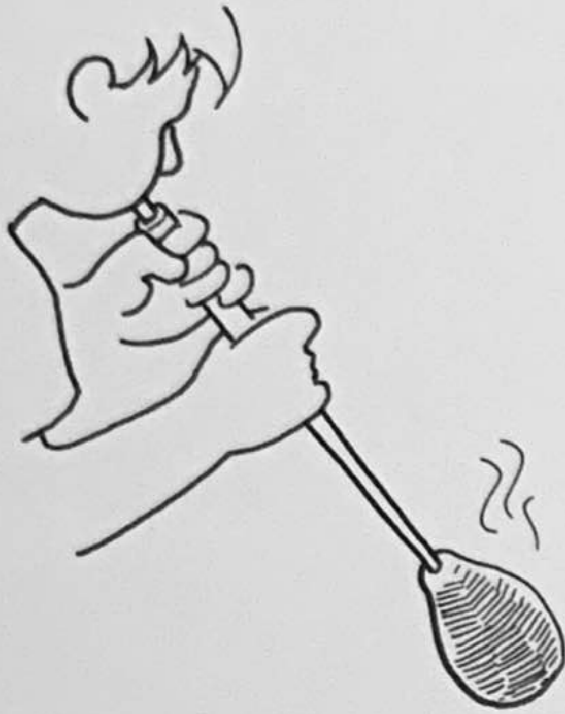
1 Am Anfang des Arbeitsprozesses steht eine kleine gelbe Glasblase, die die Farbe der fertigen Vase bestimmt.
