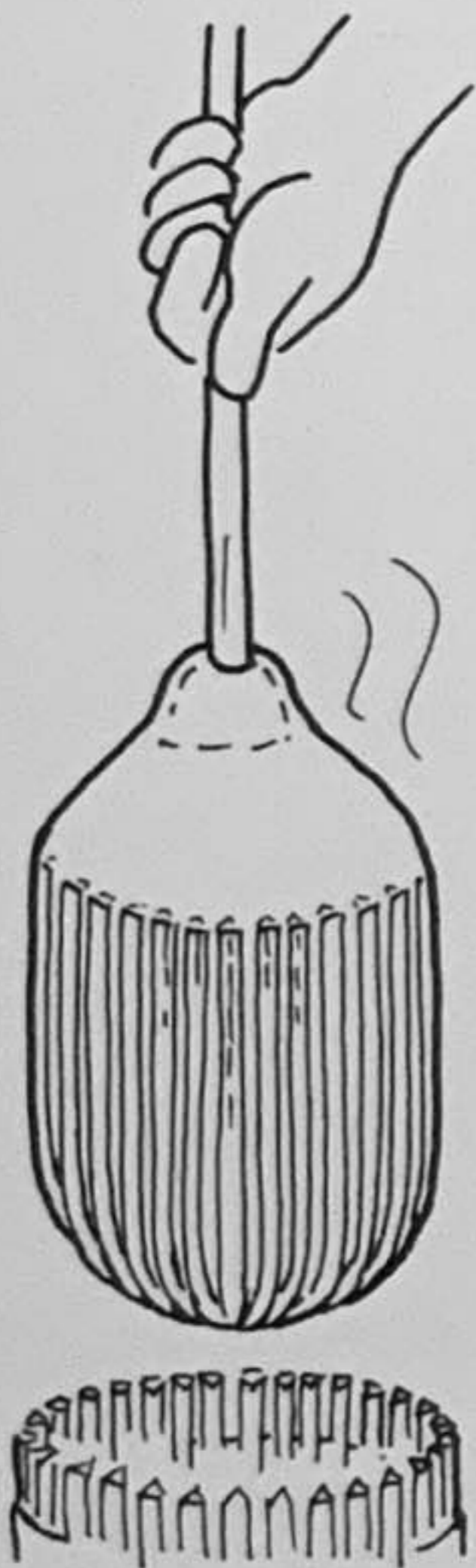
4 Die Rippen des Modells sind tief in die weiche Wandung eingeprägt.
