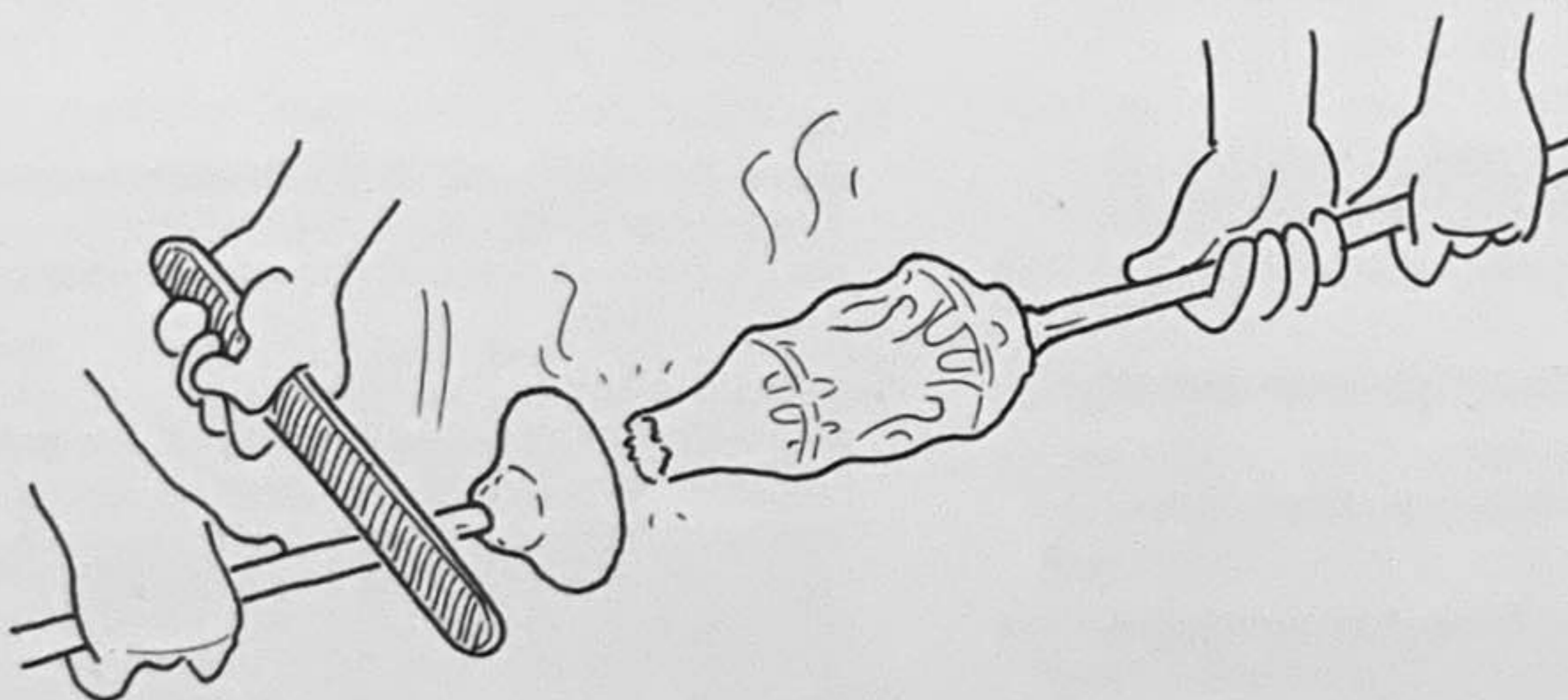
12 Das Werkstück wird vom Hefteseis über- nommen und die Pfeife mit der Kappe abge- sprengt.
