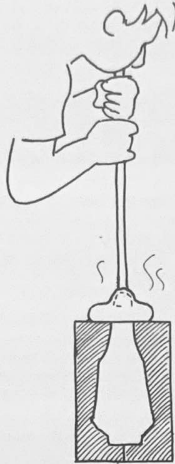
10 Im wassergetränkten hölzernen Einblasmodell erhält das Werkstück seine vorgesehene Form.
